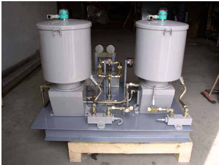
Obr. 2 Mazací stanice se dvěma mazacími přístroji osazenými plnicími i tlakovými filtry maziva.
