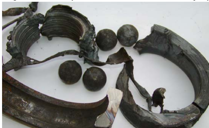
Montážna chyba –malý presah, pretáčajúce sa púzdro
