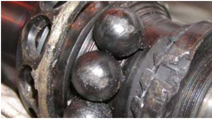
Nesprávne prevádzkovaníe – mimo povolenú oblasť
